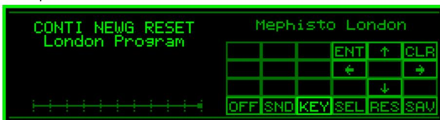
Con la tecla general **OFF**, apaga el motor como se ha explicado antes. Con la tecla **KEY** puede cambiar al modo de teclado nativo. Con la tecla **SND** puede cambiar entre “Con Sonido” o “Sin Sonido”. Con la tecla **SEL** puede elegir un nuevo emulador. Con la tecla **RES** reinicia el emulador actual. Con la tecla **SAV** puede guardar el actual estado del emulador Vancouver y similares (Solo estos pueden ser guardados).
