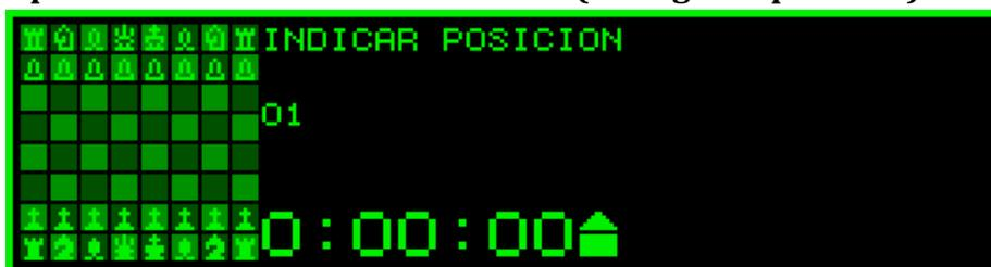
En este modo se puede configurar una nueva posición de las piezas en el tablero. Tras pulsar la tecla **ENTER** Revelation II explorará el tablero para reconocer las piezas y su posición en el tablero.
