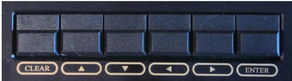
Las teclas reaccionan tras 0,1 segundos de pulsación, no pulse y suelte demasiado rápido. Si mantiene pulsado una de las teclas obtendrá una repetición de la función de esa tecla. Tras pulsar una tecla durante 3 segundos la frecuencia de repetición se incrementará.
