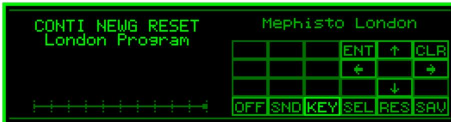
Con la tecla general **OFF**, apaga el módulo como se ha explicado antes. Con la tecla **KEY** puede cambiar al modo de teclado nativo. Con la tecla **SND** puede cambiar entre “Con Sonido” o “Sin Sonido”. Con la tecla **SEL** puede elegir un nuevo emulador. Con la tecla **RES** reinicia el emulador actual. Con la tecla **SAV** puede guardar el actual estado del emulador Vancouver y similares (Solo estos pueden ser guardados).
